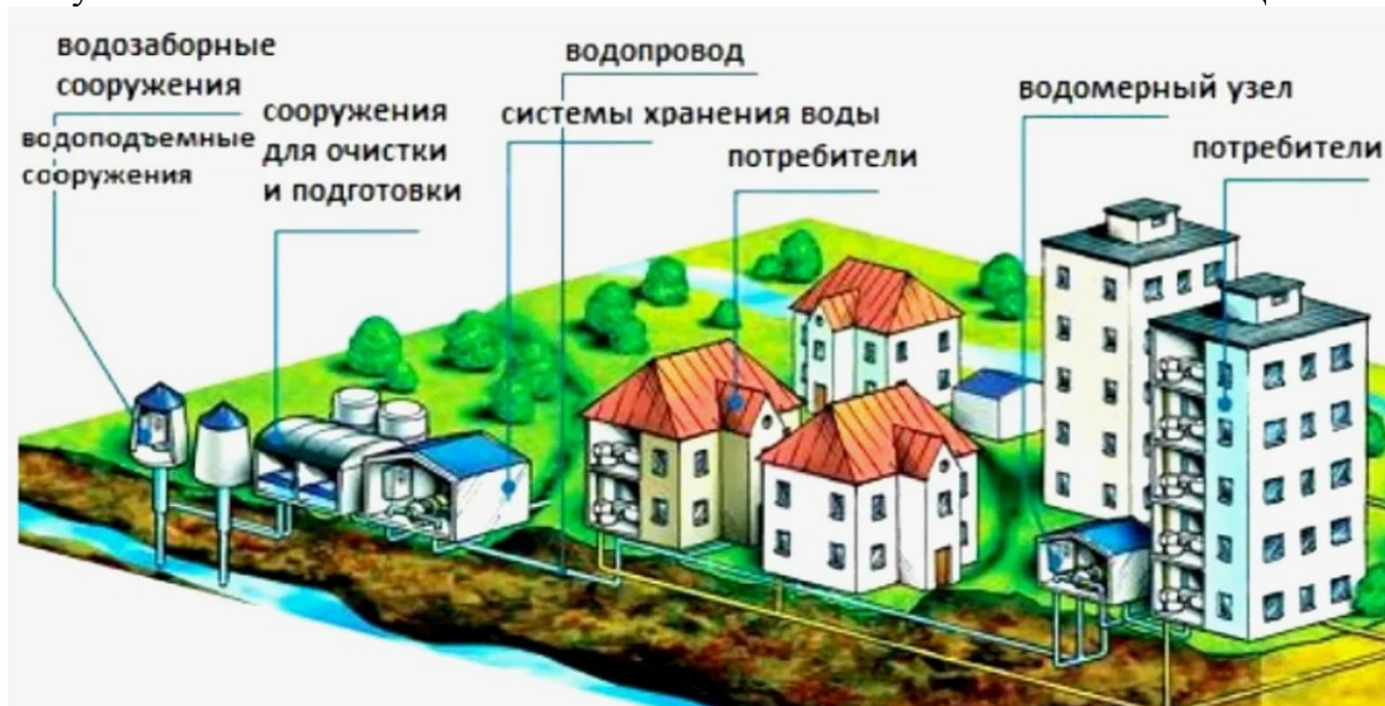
Рисунок 2 Технологическая схема источников ЦСХПВ
